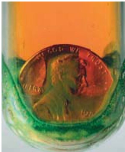
▲ El cobre metálico reacciona con el ácido nítrico ( \text{HNO}_3 ) para producir el gas \text{NO}_2 color café.
