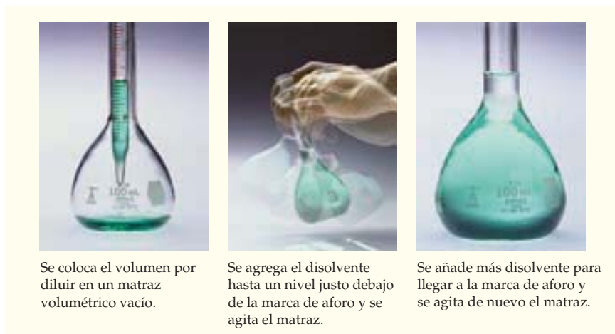
FIGURA 3.4 Procedimiento para diluir una disolución concentrada.
