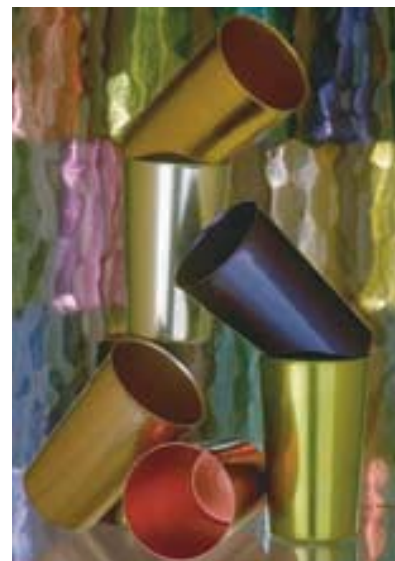
▲ Estos vasos de colores se fabrican anodizando al aluminio, que es un metal plateado.
