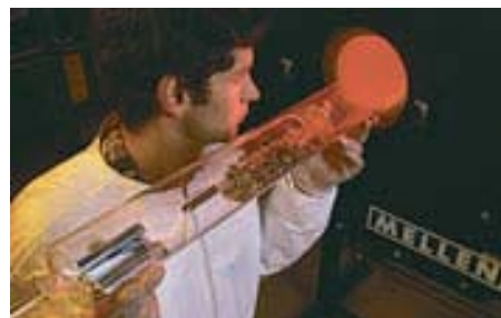
El material semiconductor arseniuro de galio se prepara calentando un tubo que contiene barras de galio metálico (izquierda) y piezas de arsénico (derecha) en un horno.
