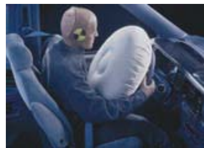
▲ Las bolsas de aire para automóviles se inflan con \text{N}_2 gaseoso producido por la descomposición de azida de sodio.
