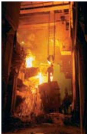
▲ El hierro crudo se convierte en acero oxidando sus impurezas con O_2 gaseoso.
