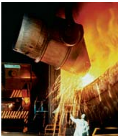
▲ Uso del proceso básico de oxígeno para producir acero.
