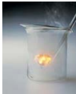
▲ El sodio se quema en presencia de cloro para dar cloruro de sodio sólido.
