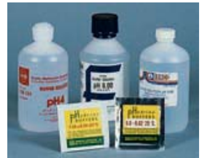
FIGURA 15.5 Disoluciones amortiguadoras envasadas de pH conocido e ingredientes sólidos para preparar disoluciones amortiguadoras de pH conocido.
