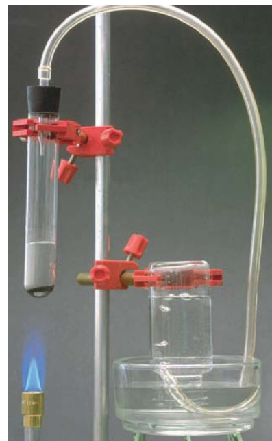
▲ El \text{MnO}_2 cataliza la descomposición térmica del \text{KClO}_3 en \text{KCl} y \text{O}_2 gaseoso.
