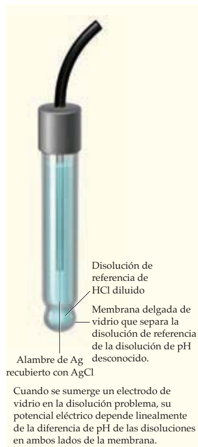
FIGURA 17.6 Un electrodo de vidrio está formado por un alambre de plata recubierto con cloruro de plata, que se sumerge en una disolución de referencia de ácido clorhídrico diluido.
