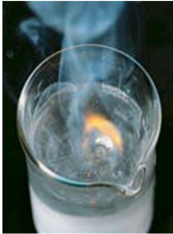
▲ El sodio, uno de los metales alcalinos, reacciona violentamente con el agua para producir hidrógeno gaseoso y una disolución alcalina (básica).
