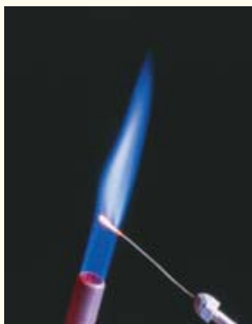
La flama se vuelve de un fugaz color violeta con el potasio.
