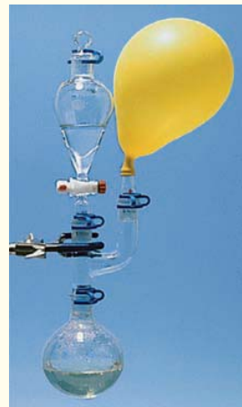
Al agregar yoduro de sodio acuoso, el globo se infla rápidamente con \text{O}_2 .
