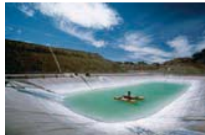
▲ Una alberca de lixiviación con cianuro, para extraer oro, en la Mina Picacho de Oro, en el desierto de Mojave.
