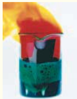
El cobre reacciona con HNO 3 , concentrado formando vapores perjudiciales de NO 2 , color marrón. El color azul de la disolución se debe a los iones Cu 2+ .
