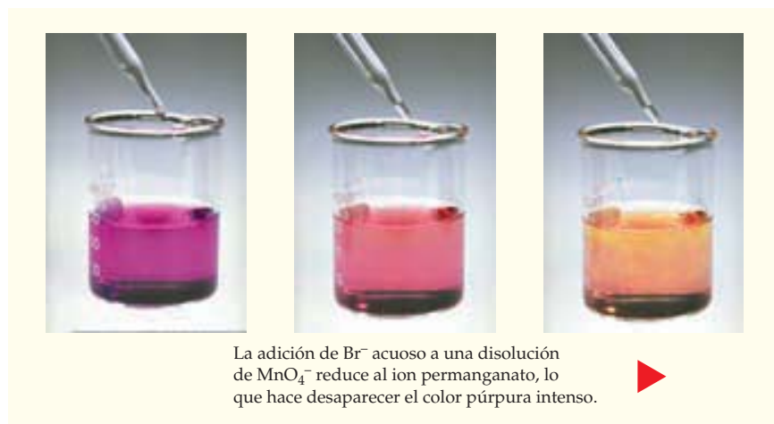
FIGURA 4.4 La reacción redox del \text{KMnO}_4 con \text{NaBr} en medio ácido.
