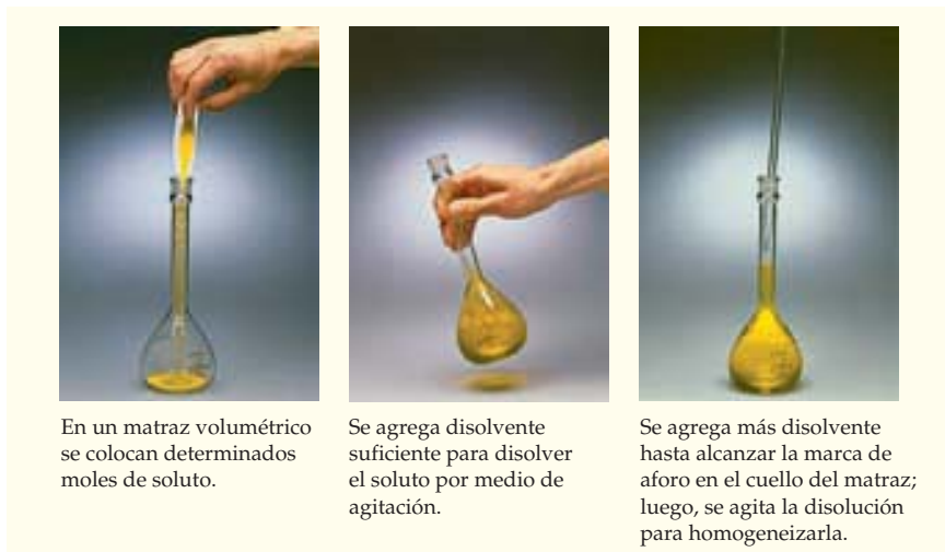
FIGURA 3.3 Preparación de una disolución de molaridad conocida.
