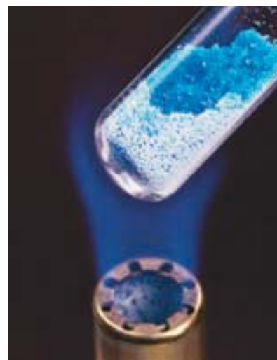
FIGURA 18.12 Los cristales azules de \text{CuSO}_4 \cdot 5\text{H}_2\text{O} se convierten en \text{CuSO}_4 anhidro blanco, cuando son calentados a la flama del mechero Bunsen.
