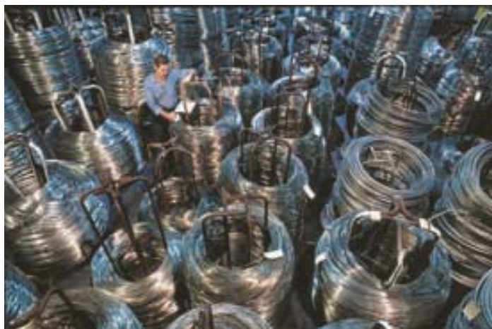
► Por su ductilidad, el aluminio se puede estirar para formar los conductores que se usan en las líneas de transmisión eléctrica.
