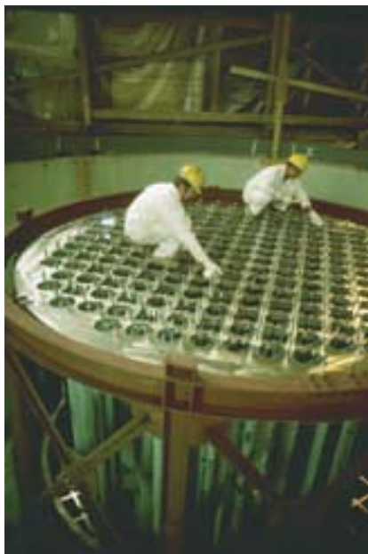
▲ El zirconio se usa para recubrir las varillas de dióxido de uranio, combustible utilizado en los reactores nucleares.
