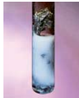
▲ El cinc metálico reacciona con el ácido clorhídrico acuoso para dar hidrógeno gaseoso y iones \text{Zn}^{2+} acuosos.
