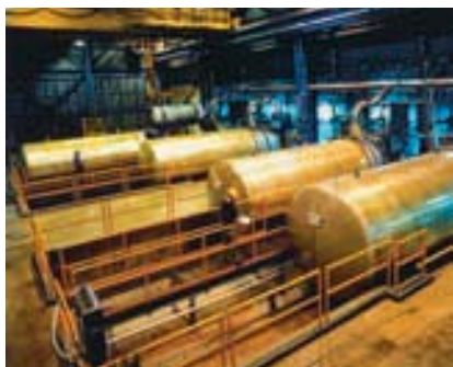
▲ El uranio-235 que se utiliza como combustible en los reactores nucleares se obtiene por medio de la difusión del gas \text{UF}_6 en estos cilindros.
