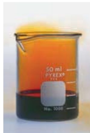
▲ Como el bromo está coloreado, es posible ver su vapor rojizo arriba del líquido.
