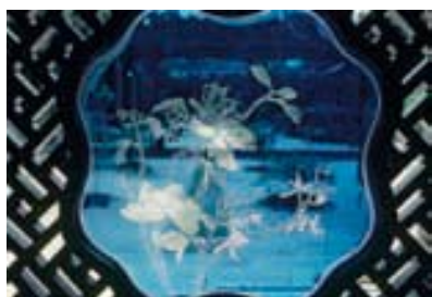
▲ El HF gaseoso es una de las pocas sustancias que reaccionan y graban el vidrio ( \text{SiO}_2 ), de acuerdo con la ecuación \text{SiO}_2(\text{s}) + 4 \text{HF}(\text{g}) \rightarrow \text{SiF}_4(\text{g}) + 2 \text{H}_2\text{O}(\text{l}) .
