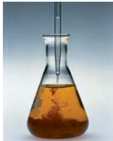
FIGURA 20.10 Cuando se agrega \text{NaOH} diluido a una disolución de sulfato de hierro(III), \text{Fe}_2(\text{SO}_4)_3 , se forma un precipitado gelatinoso café rojizo de \text{Fe}(\text{OH})_3 .
